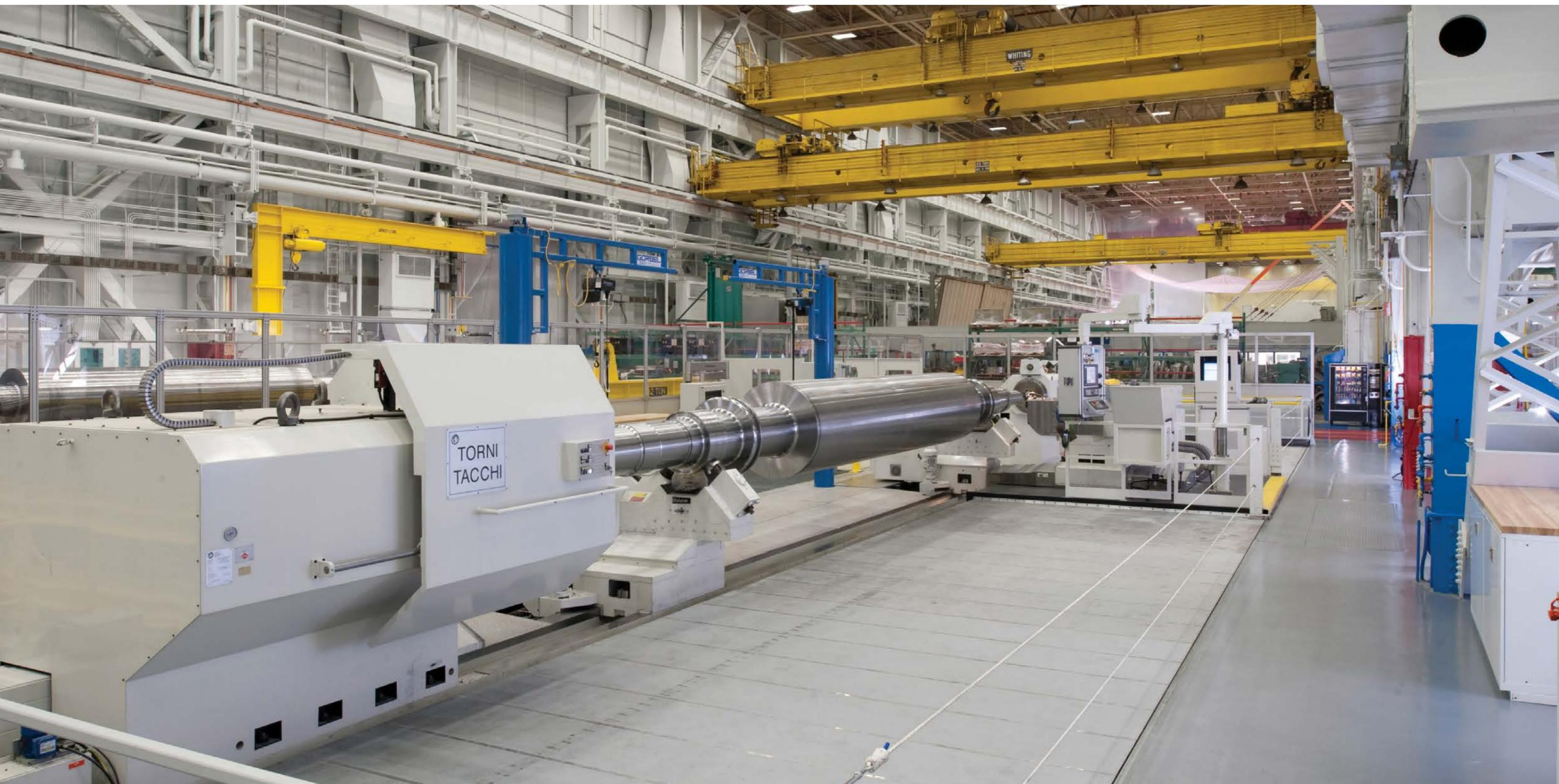
In conformità con quanto previsto nel piano "Industria 4.0", i Torni ed i Centri di Tornitura pesanti Mod. HD/4 sono predisposti all'integrazione nel contesto produttivo della fabbrica.
