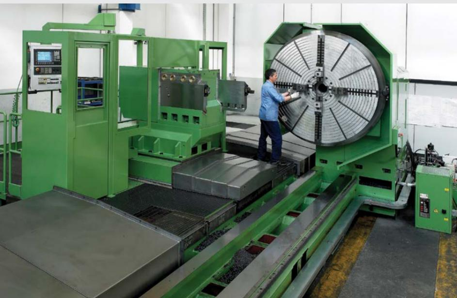
In funzione della specifica applicazione, possono essere utilizzate diverse tipologie di piattaforme, eventualmente dotate di moltiplicatore di coppia di serraggio. Nella parte frontale del mandrino è montata una corona con dentatura elicoidale, temperata e rettificata, di grandi dimensioni, grazie alla quale è disponibile un'elevata coppia.
